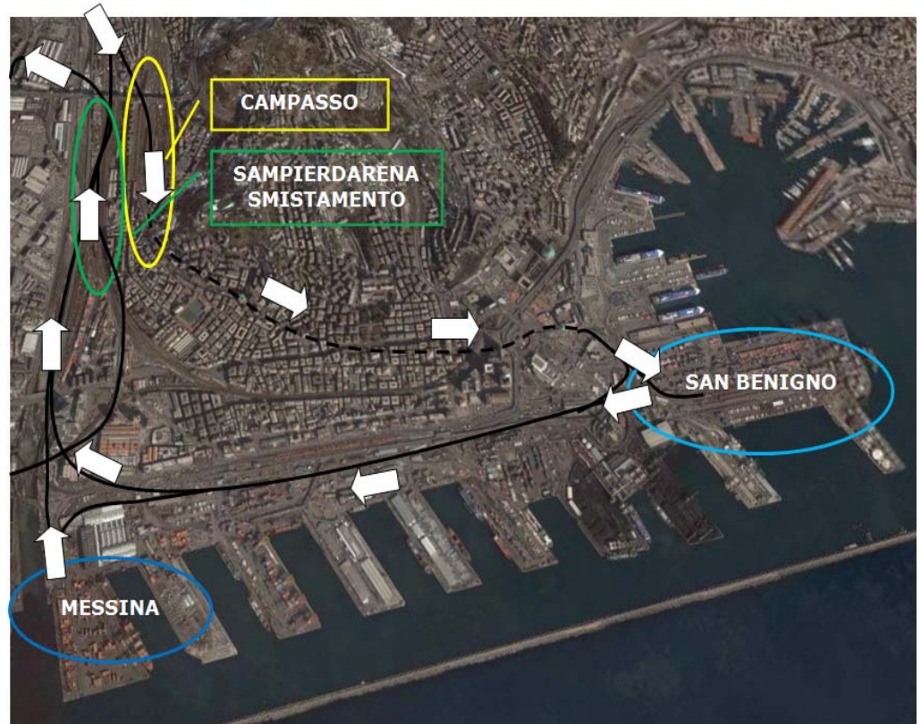
Figura 3: concetto di porto passante per il Porto di Genova (fonte: I.LOG)
