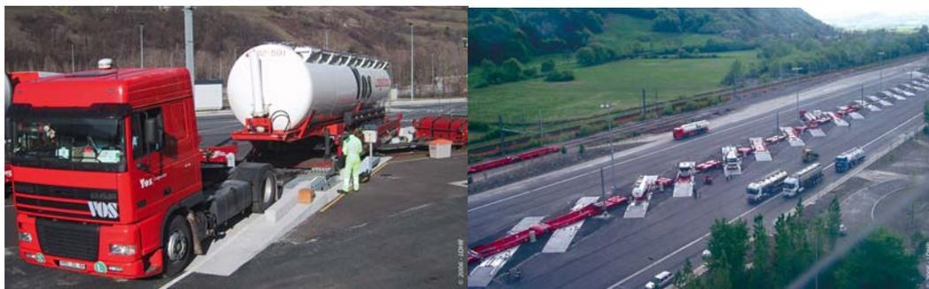
Il *Cargo Domino* è un sistema intermodale camion-treno costituito da un apparato di trasbordo orizzontale meccanico posto a bordo del veicolo stradale. I mezzi stradali dovranno essere dedicati a questo tipo di sistema di trasporto così come i contenitori. Le comuni unità di trasporto, a meno di modifiche in esse o nel pianale ferroviario, non possono essere movimentate.
